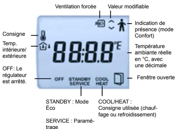
Le menu "Paramètres" permet de modifier différents paramètres via l'écran, en utilisant les boutons de commande du régulateur. Les touches AUGMENTER/DIMINUER permettent de modifier les valeurs des paramètres. Le bouton marche/arrêt permet de valider la nouvelle valeur.
