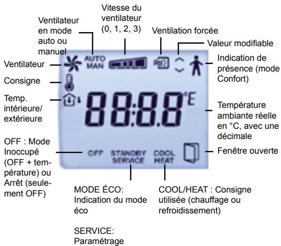
Le menu "Paramètres" permet de modifier différents paramètres via l'écran, en utilisant les boutons de commande du régulateur. Les touches AUGMENTER/DIMINUER permettent de modifier les valeurs des paramètres. Le bouton marche/arrêt permet de valider la nouvelle valeur.
