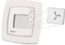
En mode de fonctionnement Arrêt ou Inoccupé, le ventilateur est arrêté, quelle que soit la vitesse indiquée à l'écran.
