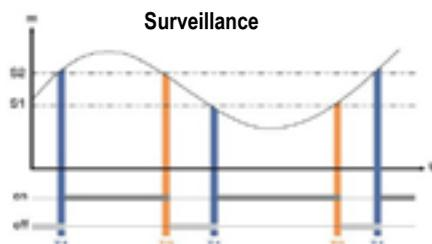
L'alarme se déclenche lorsque la mesure est en dehors du seuil haut et du seuil bas.
