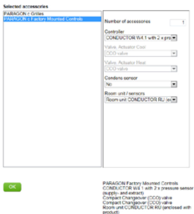
Figure 46. PARAGON c B-HC (-R) avec régulateur Conductor W4.1 installé en usine avec 2 capteurs de pression ambiants RU et vanne CCO pour refroidissement et chauffage. Voir les autres options dans le tableau ci-dessous.
