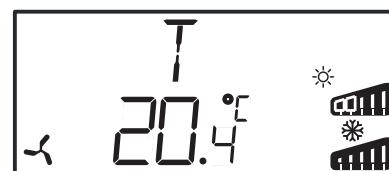
La ligne supérieure indique le mode de régulation sélectionné, soit ici le mode 1 : régulation de la température. La ligne inférieure affiche la valeur réelle.
