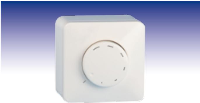
Le potentiomètre MTP est conçu pour commander l'équipement qui a besoin d'un signal de commande en continu. L'alimentation est libre dans la plage de 0 à 12 VDC. La tension de sortie souhaitée est ajustée progressivement de 0 à la tension d'alimentation (Us) par un bouton rotatif.
