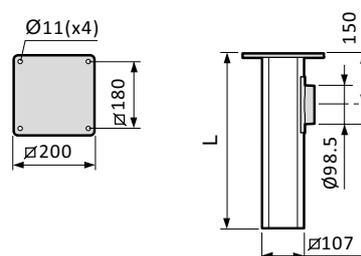
Console de fixation au plafond, pour montage sur poutraison. La plaque de fixation est réglable sur toute la longueur du profilé en aluminium, qui peut être coupé lors de l'installation en cas de besoin.
