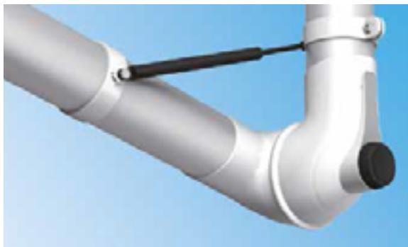
Pour les bras d'une longueur de 1,5 m et 2 m, Fumex recommande d'utiliser le modèle à ressort à gaz pour une plus grande stabilité.
