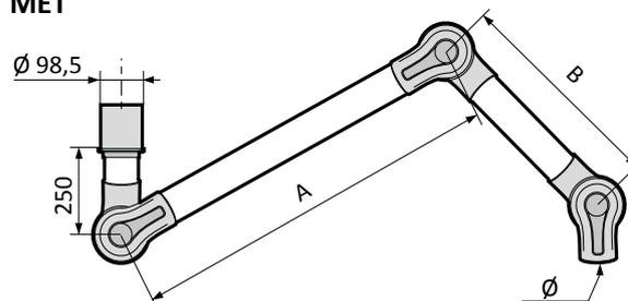
MET pour montage au plafond, sans console de fixation au plafond MTI.
