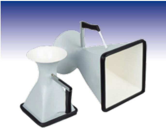
La direction et l'homogénéité du flux d'air entrant ou sortant d'une bouche aéraulique est souvent perturbée par la géométrie de cette dernière. Afin de mesurer le débit, il est souvent nécessaire d'utiliser un cône de mesure pour canaliser l'air. Associé avec l'anémomètre VTA à fil chaud, il permet la traduction d'une vitesse en m<sup>3</sup>/h.
