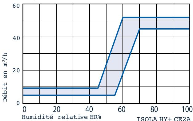
La courbe ci-contre donne les caractéristiques aérauliques nominales en fonction du taux d'humidité de l'air intérieur et pour une différence de pression de 20 Pa.
