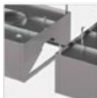
Raccordement hottes A-SK / A-SD
