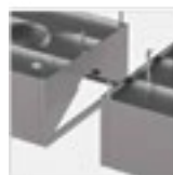
Raccordement hottes A-SK / A-SD
