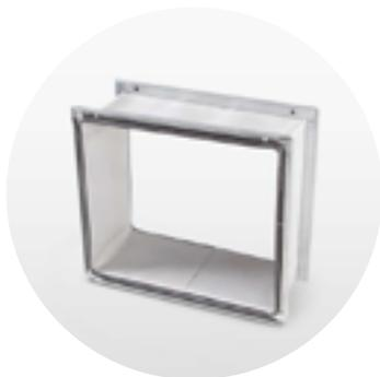
Les manchons flexibles de type MS20 empêchent que les vibrations et le bruit se transmettent dans les gaines de ventilation. Réalisé en fibre de verre, le manchon se classe en catégorie antifeu M0, et en catégorie d'étanchéité à l'air Classe B (EN 15727 et EN 1751). La plage de fonctionnement est comprise entre -30°C et +110°C, à des pressions atteignant 2000 Pa. Le cadre de connexion de 20 mm est réalisé en acier galvanisé de 1 mm d'épaisseur.
