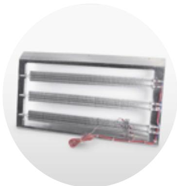
La batterie électrique assure le post-chauffage de l'air soufflé. La batterie électrique se trouve entre l'échangeur de chaleur à plaques et les raccordements pour l'air soufflé. L'équipement intègre deux dispositifs antisurchauffe: un à réarmement automatique, l'autre à réarmement manuel. Tous les raccordements électriques sont protégés contre l'électrocution.
