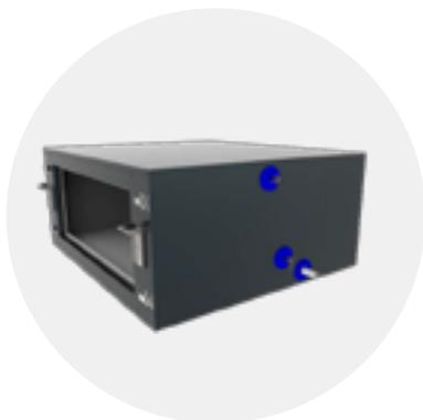
Les caissons externes isolés sont réalisés en tôle d'acier galvanisé. L'enveloppe extérieure est thermolaquée en RAL7016. Les panneaux à double enveloppe contiennent 30 mm de laine minérale. Le caisson permet également d'intégrer des batteries de refroidissement, chauffage ou à détente directe (EBA). Le cadre de raccordement standard est 15 mm, les autres types de cadres de connexion sont disponibles en option: profils en C 20 mm, cadre METU 30 mm.
