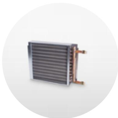
La batterie à eau EBA assure le post-chauffage de l'air soufflé. La batterie doit être intégrée dans un caisson ECA isolé. Les échangeurs de chaleur avec tuyaux à ailettes se composent de tuyaux en cuivre et d'ailettes en aluminium espacées de 2,5 mm. Le tuyau à filetage mâle est en laiton. Les batteries de classées en catégorie PN16.
