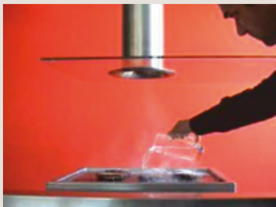
Essai fonctionnel de la platine d'extraction avec ajout d'eau sur plancha en charge
