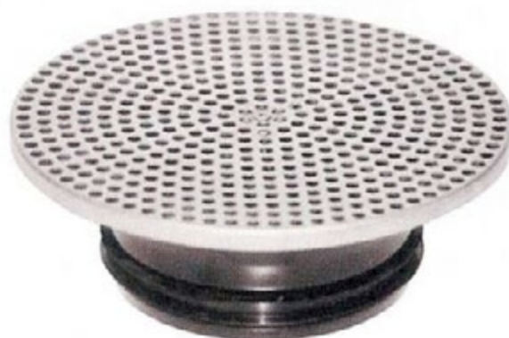
Grille de soufflage avec trous de 5,5 mm, fixation par vis centrale et finition brossée
