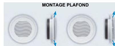
Grille fermée Obturateur position 1 Sans déflecteur Grille fermée Obturateur position 2 Avec ou sans déflecteur
