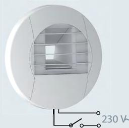
Principe : la bouche temporisée est alimentée par l'intermédiaire d'un contact normalement fermé. Une impulsion sur celui-ci crée une coupure d'alimentation qui enclenche l'ouverture de la bouche au débit maximum d'extraction. Délai d'ouverture environ 60 secondes.
