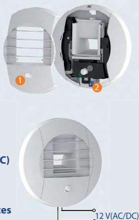
Principe : la bouche est alimentée par un câble 2 fils (2 x 1,5 mm<sup>2</sup>) à encastrer débouchant à l'arrière de la platine support (schéma ci-contre). Prévoir un transformateur 12 V(AC/DC), 1 A, au tableau électrique.
